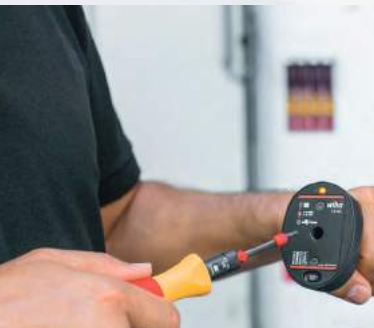
Мобильная проверка динамометрических инструментов
