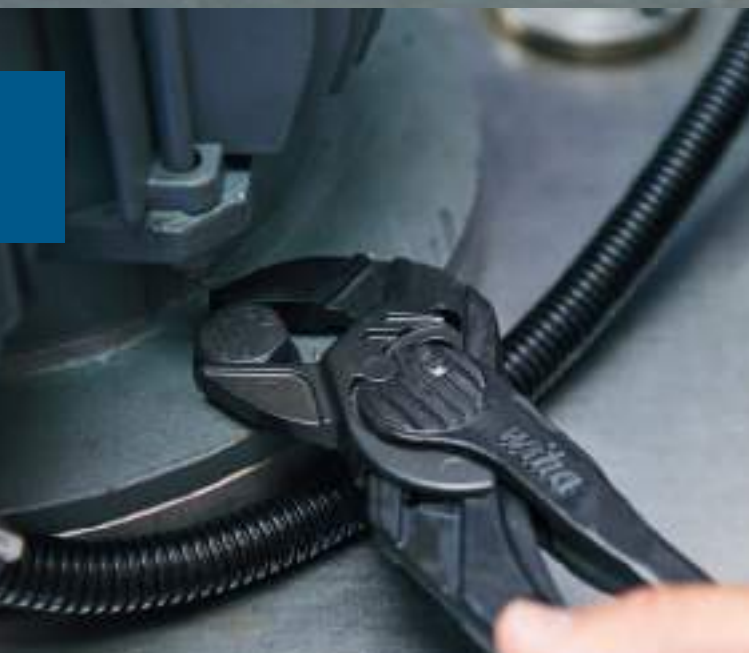
Самоторможение начиная с размера ключа 17 мм
