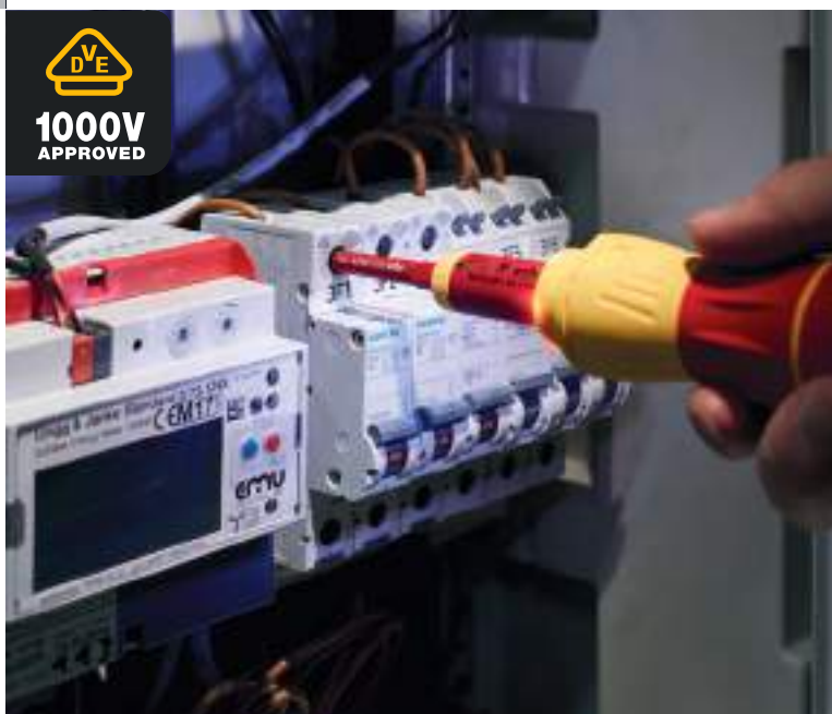
Безопасные инструменты с сертификатом VDE до 1 000 В перем. тока
