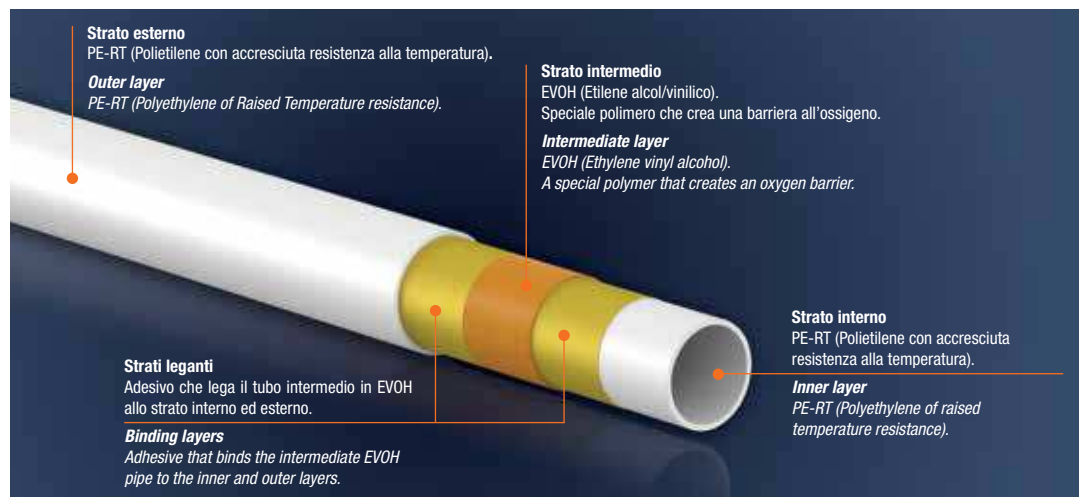
Stratigrafia tubo polipert Polipert pipe stratigraphy
