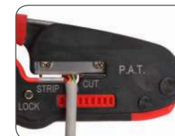
Зачистка круглого провода
