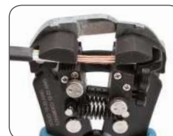
Одновременное снятие изоляции с трех проводов
