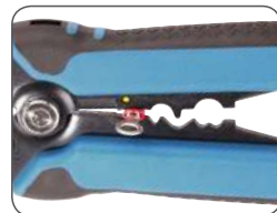
Опрессовка изолированного наконечника
