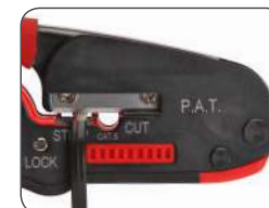
Зачистка плоского провода
