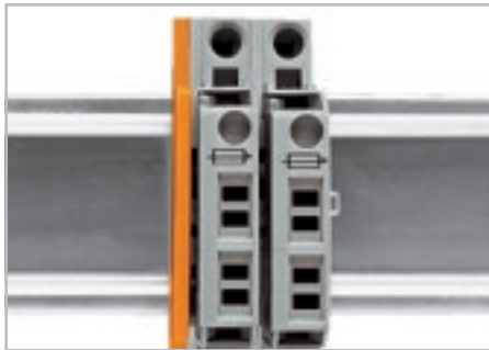
Разделитель входит в стандартное оснащение для клеммы с предохранителями шириной 10 мм. В конце монтажа, при отсутствии смежной клеммы с предохранителем, необходимо использовать торцевую пластину.
