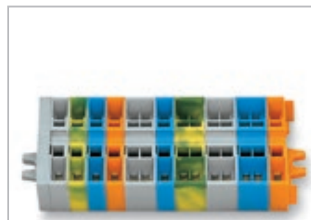
Клеммная колодка с крепежными фланцами состоит из: - торцевой пластины с крепежным фланцем - центральных клемм - оконечной клеммы с крепежным фланцем
