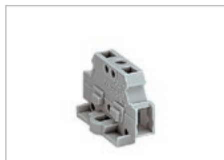
Клемма с крепежным фланцем, для винтового или аналогичного способа крепления, крепежное отверстие 3,2 мм Ø (с монтажным адаптером 209-123 также для DIN-рейки 35 мм) Возможность боковой маркировки с помощью маркировочной системы Mini-WSB Quick, тестовый разъем.
