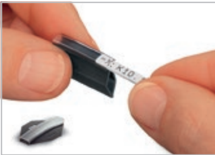
Вставьте маркер для принтера в паз для маркировочного манжеты. Замена маркера возможна и после подключения проводника.
