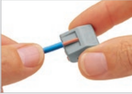
Зачистите проводник на 9 ... 10 мм.
