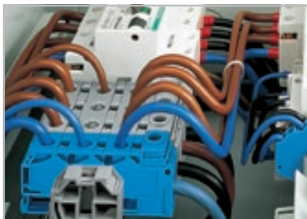
Распределительные клеммы, монтируемые на рейку с соединением винтовым зажимом 35 мм 2 /AWG 2 (фронтальный вход) и соединением 3 x 10 мм 2 /AWG 8 CAGE CLAMP® с фронтальным входом. Для монтажа на несущие рейки DIN 35 согласно EN 60675. Клемма закрыта с обеих сторон, торцевая или промежуточная пластина не требуется.
