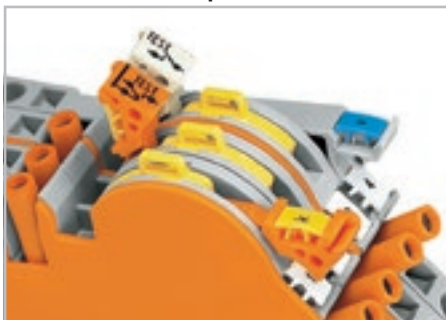
Блокиратор включения устанавливается со щелчком в два заданных положения, предотвращая случайное включение разомкнутой линии.
