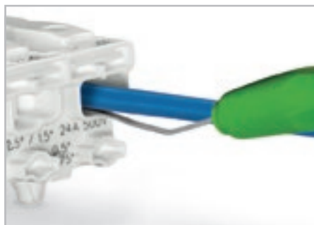
Для извлечения подсоединенного проводника Заведите инструмент для извлечения проводников под проводник и вытяните его вместе с инструментом.
