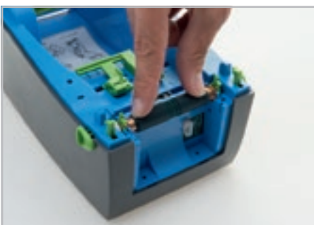
Вставьте и зафиксируйте подходящий ролик в принтере.
