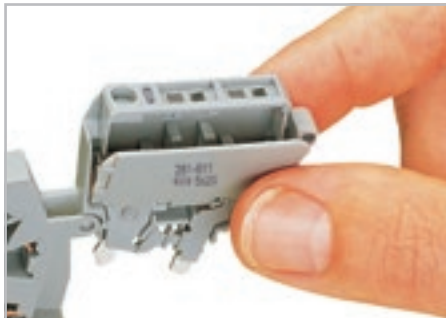
Вставьте новый предохранитель и закройте крышку.
